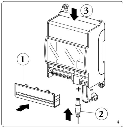
Dopo aver alimentato la caldaia e il modulo Wi-Fi (Fig. 4, Rif. 2) attendere circa 30 secondi prima di effettuare la configurazione in modo che la comunicazione fra modulo Wi-Fi e caldaia si sia stabilizzata.
