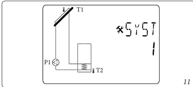
La carica del serbatoio 1 è possibile se la differenza di temperatura "dt" tra il collettore (T1) e il serbatoio 1 (T2) è sufficiente.
