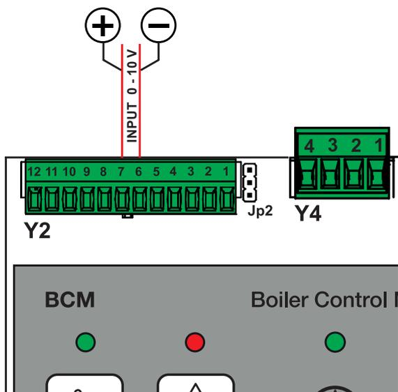
Con questa configurazione il sistema imposterà una temperatura in base alla tensione ricevuta dell'ingresso 0 - 10 V.
