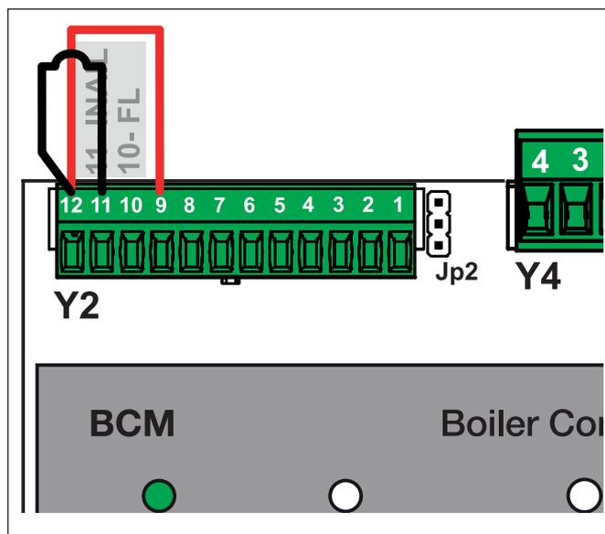
Collegando una sonda per accumulo, **Stemp ACC**, in modo automatico, il parametro **803 Srv** assume il valore **27** e viene richiesta su HSCP la riconfigurazione impianto (di fatto il salvataggio della nuova configurazione).
