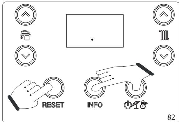
La funzione si attiva da caldaia in "off" premendo e mantenendo premuto per più di 5 secondi i pulsanti "RESET", "INFO" e "ON/OFF".
