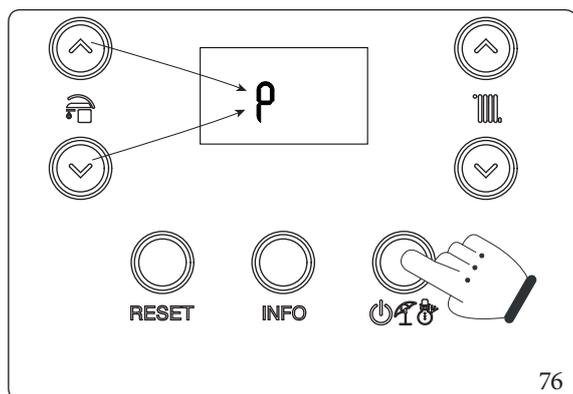
Una volta entrati nel menù è possibile scorrere ciclicamente i quattro sotto menù presenti (P, t, A, S) premendo i pulsanti dell'acqua sanitaria "6", per entrare nel menù premere il pulsante "MODE".
