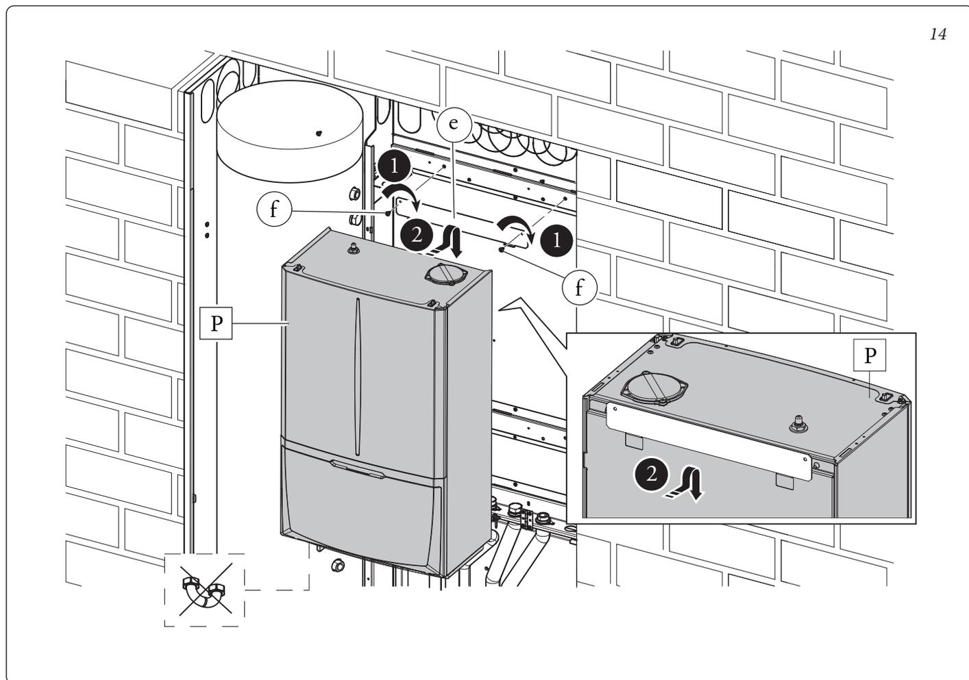
**Attenzione:** (Fig. 15): smontare dall'Unità Interna Magis Pro V2 la griglia e il rubinetto gas a squadro. Rimuovere il rubinetto a squadro posizionato sul ritorno dell' Unità interna Magis Pro V2 ed inserire il filtro a Y con i relativi tubi di collegamento come mostrato in Fig. 15.
