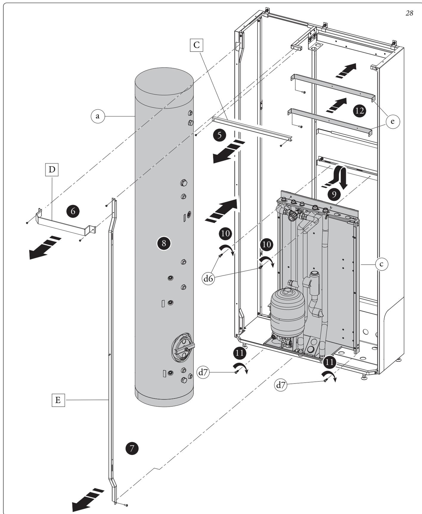
Eseguire l'assemblaggio del rubinetto di svuotamento bollitore con il relativo tubo di collegamento identificato con la sigla AF (fig.29). Collegare con il gruppo precedentemente assemblato l'unità bollitore (a) con il gruppo idronico monozona (c).
