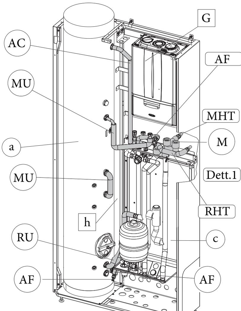
Utilizzando i tubi presenti all'interno della scatola accessori, eseguire i restanti collegamenti idraulici tra Unità Bollitore (a), Gruppo idraulico monozona (c) e Unità Interna Victrix Hybrid Plus (G), come evidenziato in Fig. 35.
