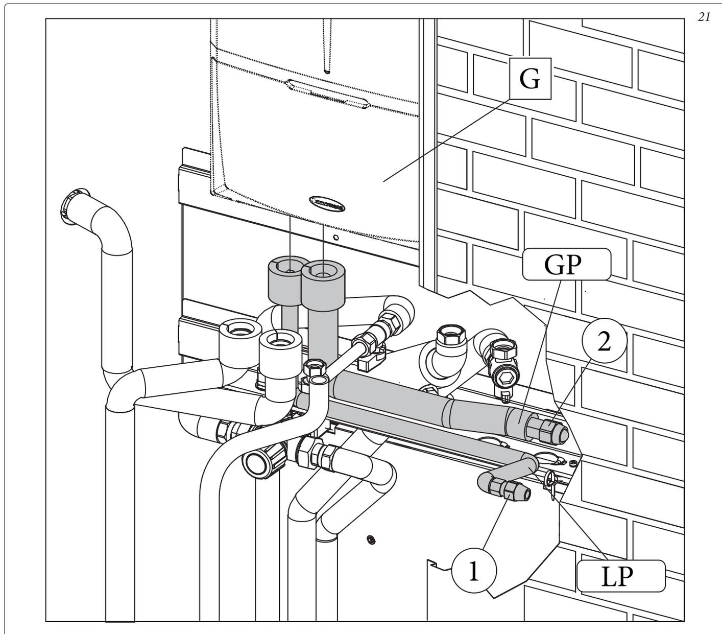
Utilizzando i tubi presenti all'interno della scatola accessori, eseguire i restanti collegamento idraulico tra Unità Bollitore (a), Gruppo idraulico monozona (c) e Unità Interna Magis Combo Plus V2 (G), come evidenziato in Fig. 22.
