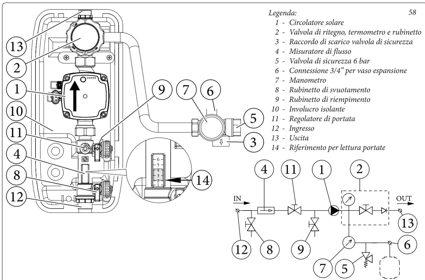
dell'unità interna, della pompa di calore e dell'impianto termico. Il circolatore può risultare rumoroso all'avviamento per la presenza di aria. Tale rumore dovrebbe cessare dopo pochi minuti di funzionamento e comunque dopo aver effettuato lo spurgo dell'aria contenuto nel circuito idraulico in maniera corretta.
