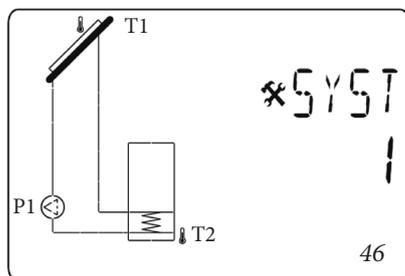
La carica del serbatoio 1 è possibile se la differenza di temperatura "dt" tra il collettore (T1) e il serbatoio 1 (T2) è sufficiente.
