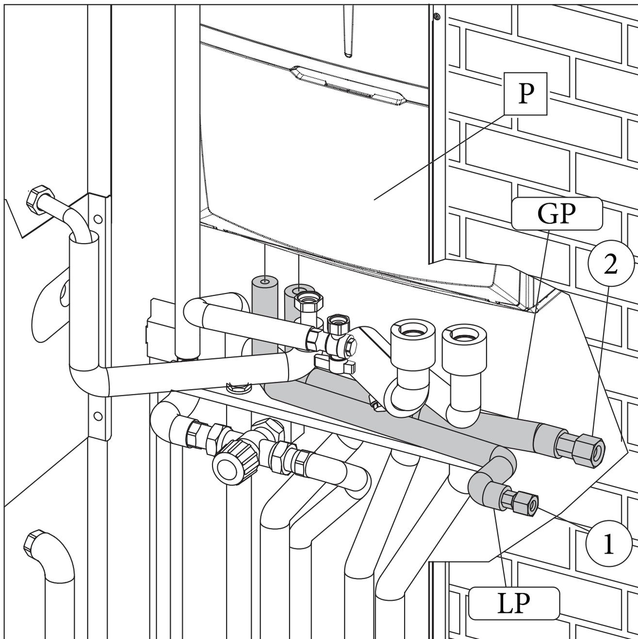
Utilizzando i tubi presenti all'interno della scatola accessori eseguire i restanti collegamento idraulico tra Unità Bollitore (a), Gruppo idraulico monozona (c) e Unità Interna Magis Pro V2 (P), come evidenziato in Fig. 17.
