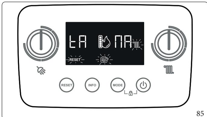
Una volta attivata la funzione il simbolo service (☹️) inizierà a lampeggiare. Sui digit di sinistra verrà visualizzato "tA" mentre su quelli di destra verrà visualizzata la temperatura di mandata alternata all'indicazione (MA, AC, Mi) della fase in corso, a seconda dell'avanzamento della taratura:
