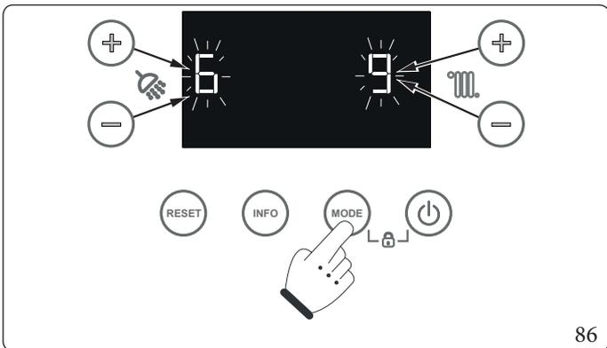
Per inserire la cifra di sinistra utilizzare i pulsanti +/- (5-6) per la regolazione della temperatura dell'acqua sanitaria (🚿) per inserire la cifra di destra utilizzare i pulsanti +/- (7-8) per la regolazione temperatura riscaldamento (🔥).
