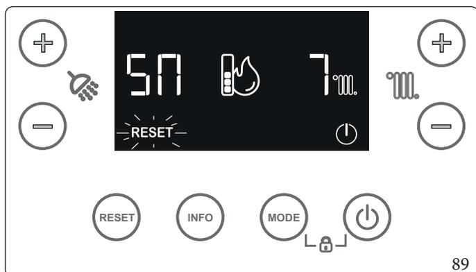
Con funzione attiva sul display compare in maniera alternata il conto alla rovescia dei giorni e della temperatura di mandata corrente, contemporaneamente alle normali informazioni di funzionamento (simbolo fiamma, anomalie).
