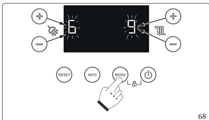
Per inserire la cifra di sinistra utilizzare i pulsanti +/- (5-6) per la regolazione della temperatura dell'acqua sanitaria (☼); per inserire la cifra di destra utilizzare i pulsanti +/- (7-8) per la regolazione temperatura riscaldamento (🌊). La conferma della password avviene premendo il tasto MODE.
