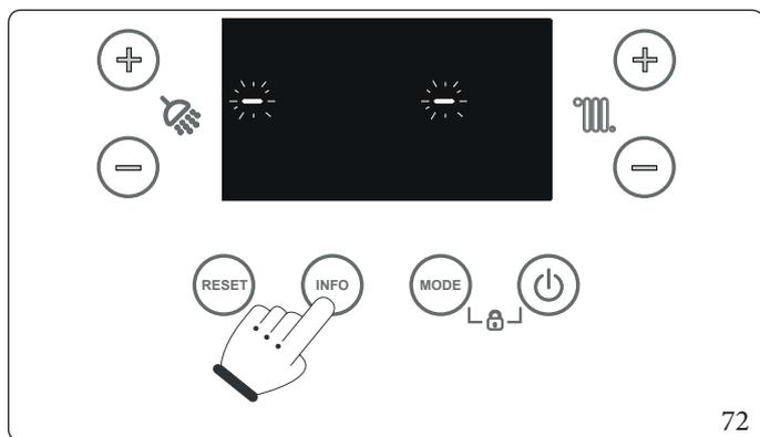
Per accedere alla funzione di taratura manuale occorre premere e mantenere premuto per un tempo maggiore di 5 secondi il pulsante "INFO"; sul display compariranno due trattini "-" singoli lampeggianti ed è necessario inserire la password (69) per l'accesso ai menù di programmazione.
