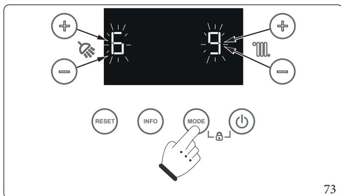
Per inserire la cifra di sinistra utilizzare i pulsanti +/- (5-6) per la regolazione della temperatura dell'acqua sanitaria (☼); per inserire la cifra di destra utilizzare i pulsanti +/- (7-8) per la regolazione temperatura riscaldamento (°C). La conferma della password avviene premendo il tasto MODE.
