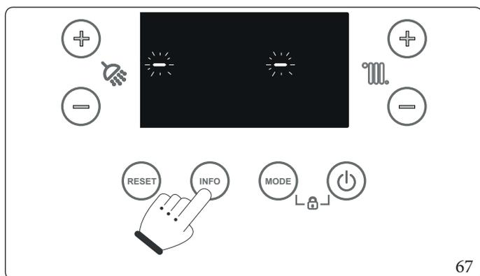
Per accedere alla funzione di taratura automatica occorre premere e mantenere premuto per un tempo maggiore di 5 secondi il pulsante "INFO"; sul display compaiono due trattini "-" singoli lampeggianti ed è necessario inserire la password (69) per l'accesso ai menù di programmazione.
