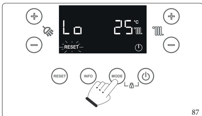
Attivando la funzione appare il set di temperatura inferiore (default 25°C, range 20 ÷ 45°C) modificabile agendo sui pulsanti +/- (pos. 7-8, Fig. 59) per la regolazione della temperatura impianto (°C) ed infine confermabile premendo il tasto "MODE". Il set modificato lampeggia dopo 2 secondi dall'ultima pressione di un tasto.
