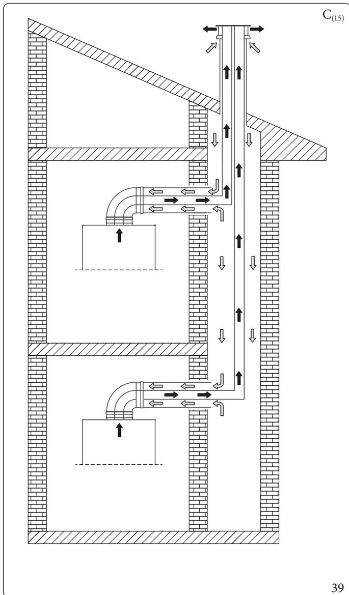
L'installazione in configurazione C<sub>(15)</sub> di un apparecchio Immergas, permette di effettuare l'aspirazione dall'aria comburente direttamente dal cavedio dove è presente lo scarico dei fumi in canna fumaria dedicata.
