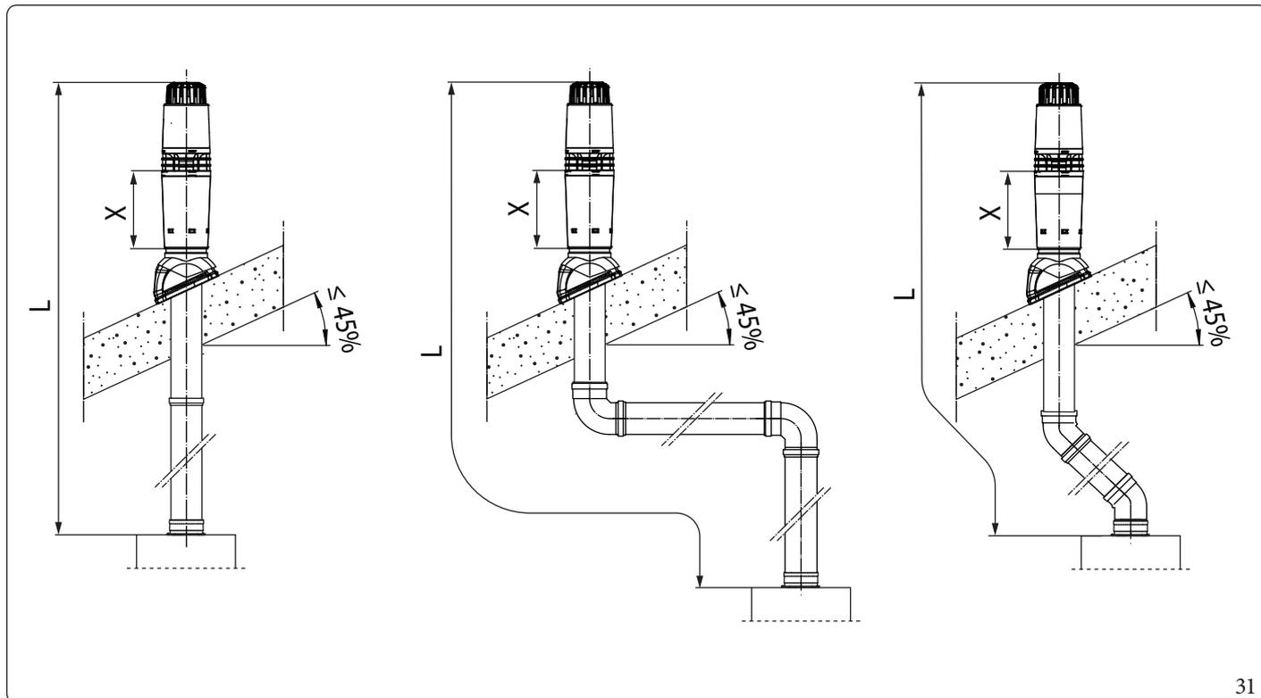
**i** Per il calcolo della lunghezza equivalente della fumisteria (L), è sufficiente sommare, per ogni componente che si intende utilizzare, il corrispondente valore indicato nella colonna "Lunghezza equivalente in m di tubo" della tabella nel paragrafo 1.14, e verificare che la somma risultante, sia uguale o inferiore alla lunghezza massima (L max) indicata nel paragrafo 1.15 ( $L \leq L_{max}$ ).
