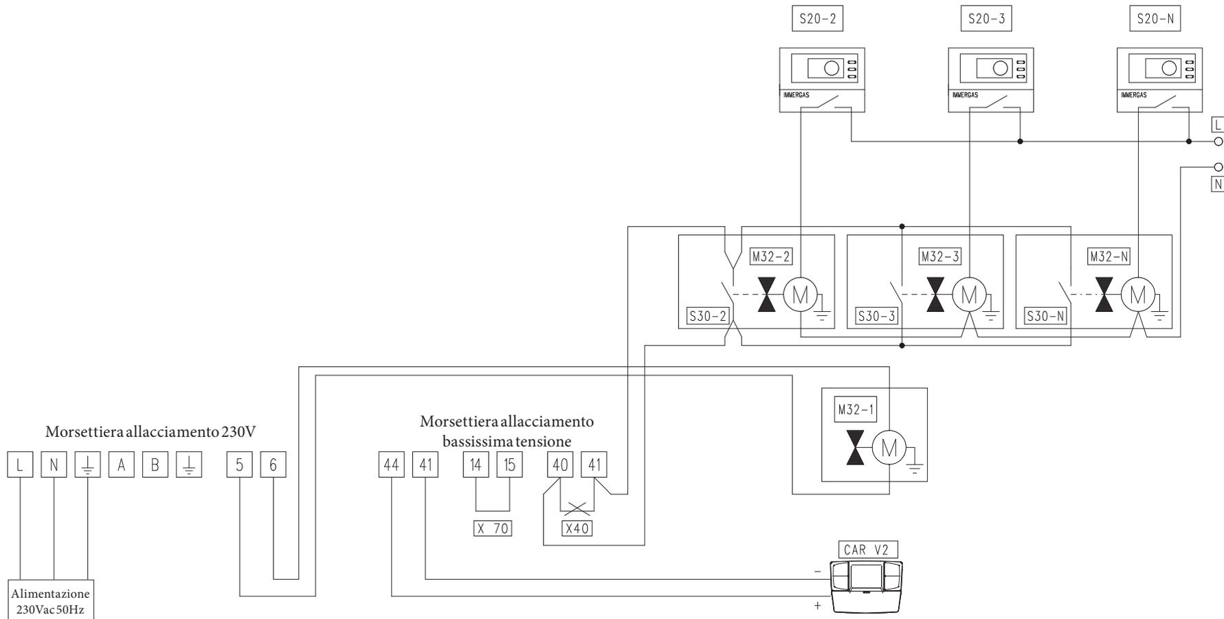
Configurazione necessaria su scheda caldaia:
