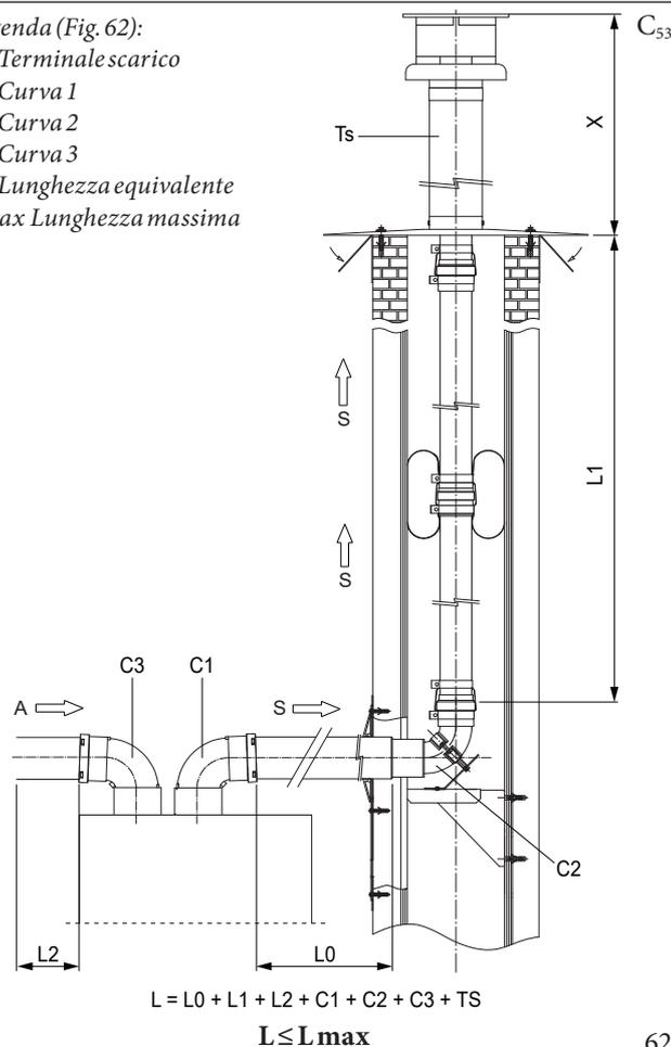
Nelle configurazioni intubamento flessibile e rigido  $C_{53}$  la lunghezza massima ( $L_{max}$ ) non comprende le 3 curve e il terminale di scarico, quindi vanno considerate nel calcolo della lunghezza equivalente ( $L$ ).
