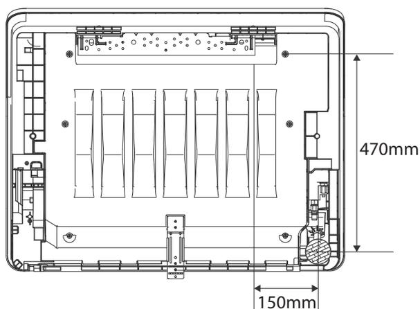
Posizione e dimensioni raccomandate del tubo di scarico posteriore attraverso il foro nel muro.
