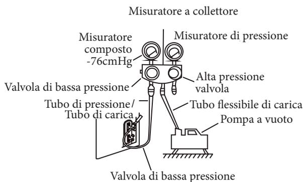
6. Chiudere il lato di bassa pressione del manometro del collettore e spegnere la pompa del vuoto.
