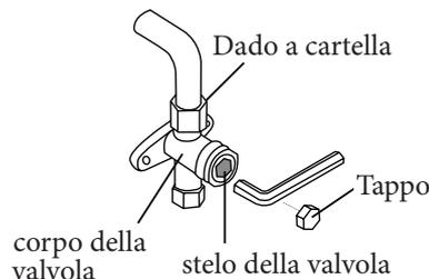
12. Con la chiave esagonale, aprire completamente le valvole di alta e bassa pressione.
