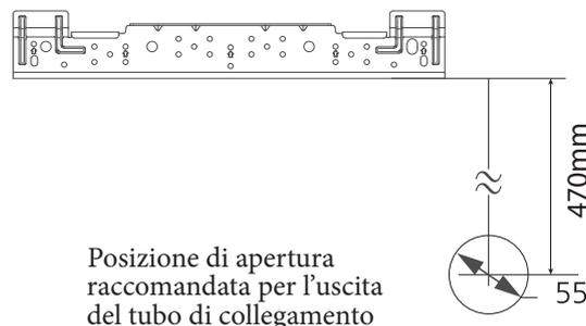
Posizione di apertura raccomandata per l'uscita del tubo di collegamento
