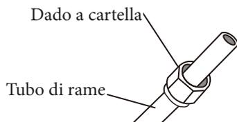
4. Rimuovere il nastro in PVC dalle estremità del tubo quando si è pronti a eseguire il lavoro di svasatura.
