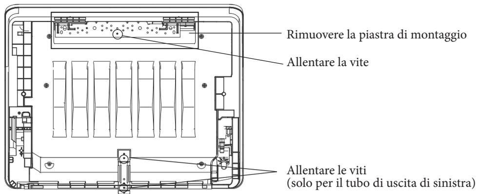
NOTA: Se il tubo esce a sinistra, è necessario allentare le viti della piastra di montaggio inferiore. Se il tubo esce in altre direzioni, non è necessario.
